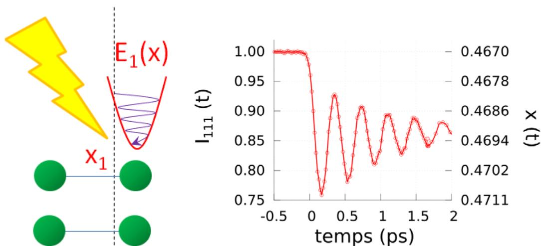
Activation d'un phonon cohérent du Bismuth par impulsion laser, observée par diffraction X femtoseconde.
